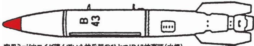
空母ミッドウェイが積んでいた核兵器のひとつ：B43核弾頭（水爆） 爆発力1メガトン 4.09m×直径0.46m 962kg
